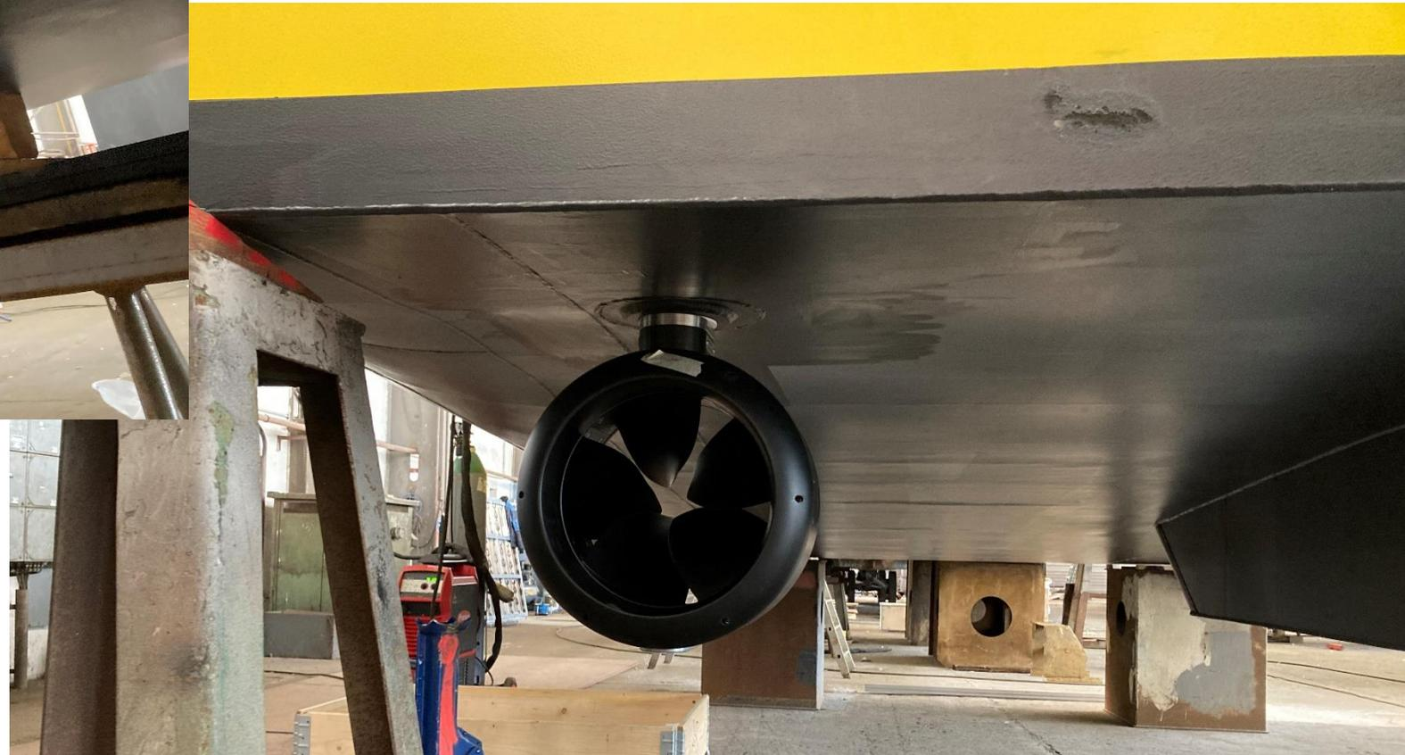
Backbord – Heckantrieb 25 kW →
