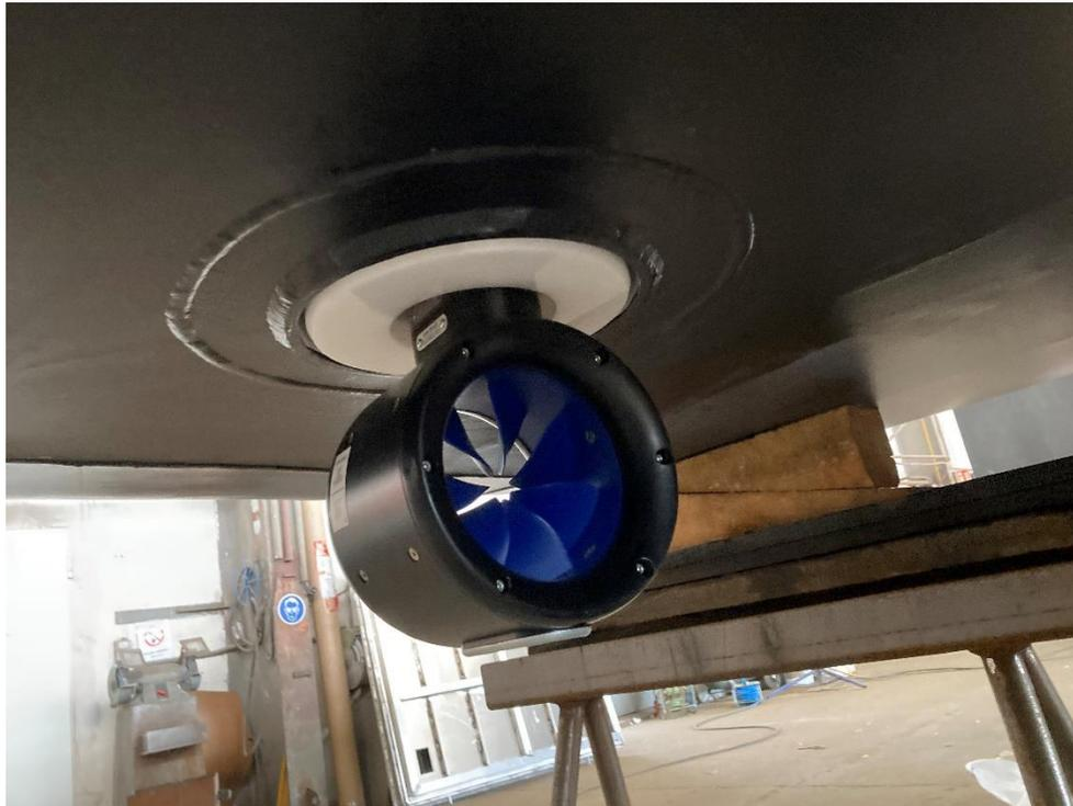
← Steuerbord – Bugantrieb 5 kW
