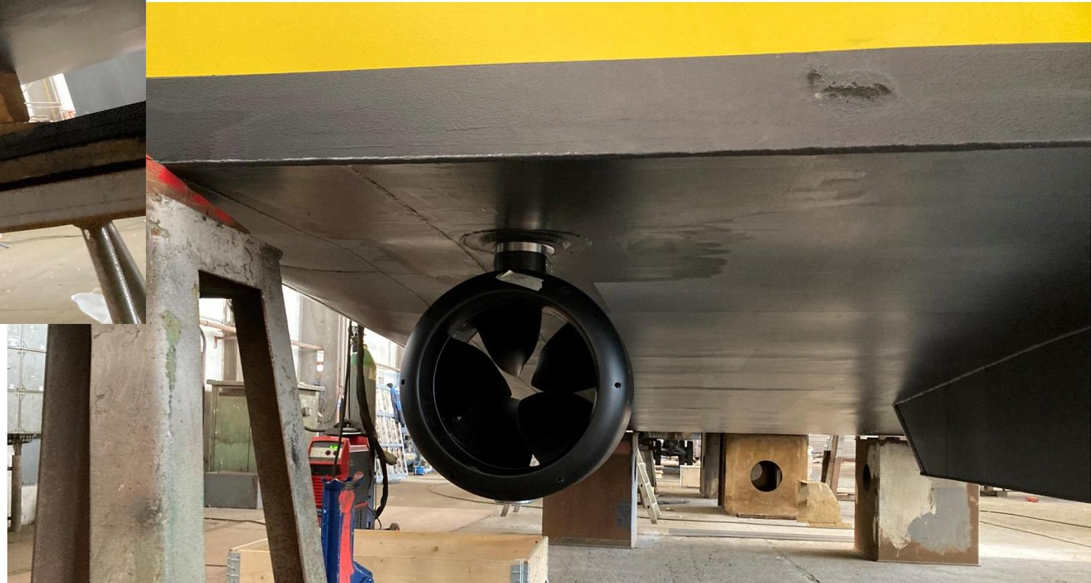
Backbord – Heckantrieb 25 kW →
